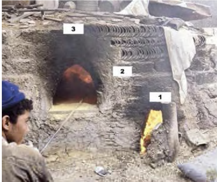
Fig. 3: "Armele", quemando: 1 puerta para el fuego; 2 apertura en el interior, donde pasan el fuego y los gases calientes; 3 salida = sitio para deponer y oxidar los metales (taller en Fez, 1999: foto y elaboración de la autora).
