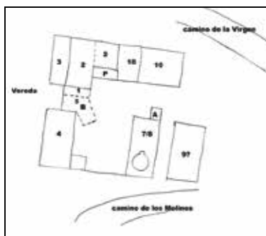
Fig. 5: Croquis de la fábrica Sirera (elaboración: Rainer Meissner): 1 – bombos, 2 - vivienda, 3 – almacén, 4 – obrador, 5 pilón y - B – balsas, 10 – cuadras, P – pila, 7/8 – horno, A – “armele”.
