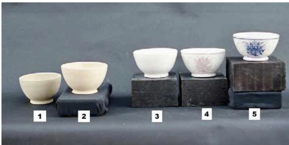
Fig. 2: Las diferentes fases de fabricación de loza: 1 pieza de barro local seco; 2 bizcochada; 3 barnizada; 4 decorada; 5 cocida por segunda vez (elaboración de la autora).
