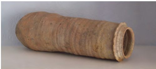
Olla de reverbero. Archivo Minas de Almadén. H = 51 cm. Ancho irregular = 16,5 cm. Boca = 11 cm.
