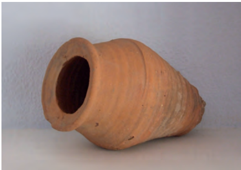
Olla de un horno de xabeca de Almadén. H=30 cm. Boca interior = 9 cm. Ancho = 20 cm.
